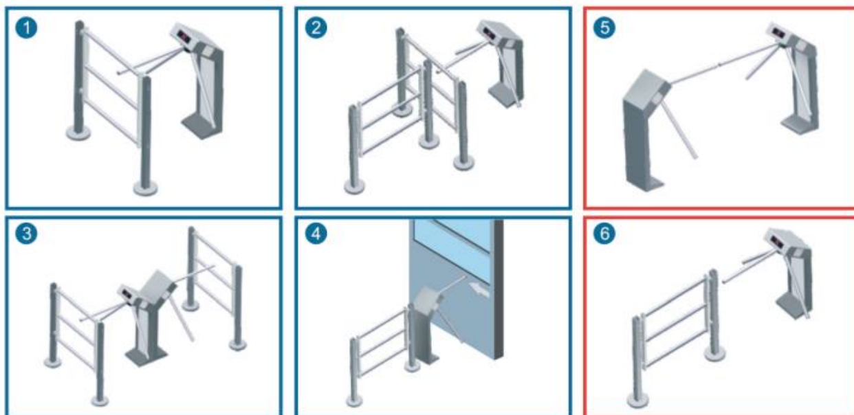
① ② ③ ④ Монтаж турникета произведен правильно ⑤ ⑥ Монтаж турникета произведен неправильно
