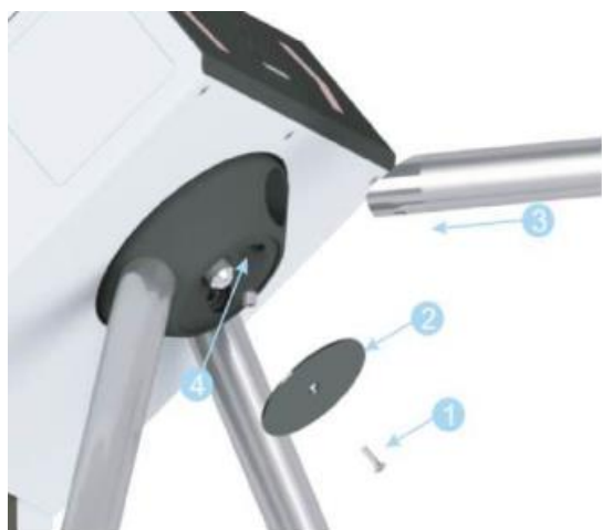
Рисунок 7.5.1 - Установка стандартной преграждающей планки
