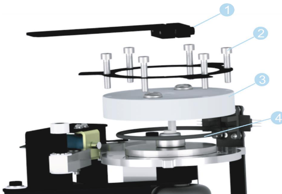
Рисунок 12.3.1 - Порядок замены уплотнительного кольца.
